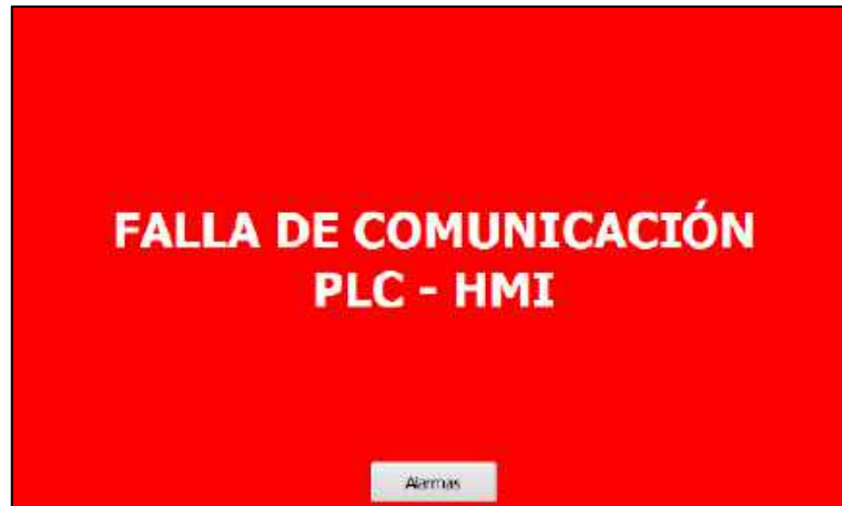
Figura 22 - Falla de comunicación PLC-HMI
