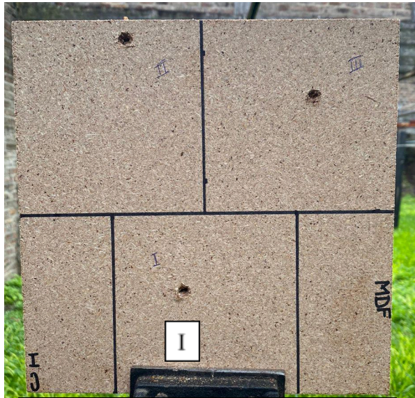
Cara incidente luego de ser penetrada por proyectiles de metal con punta ojival truncada.
