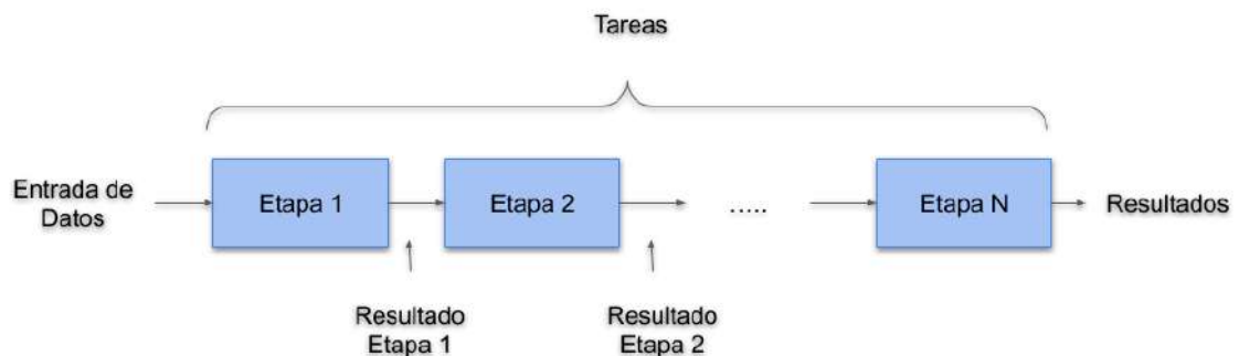
Figura 2.7. Descomposición Funcional: Estructura Pipeline.
