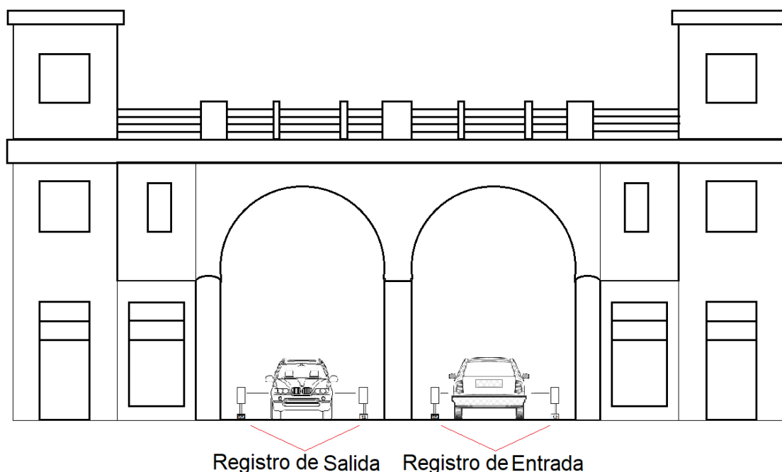
Imagen 47 - Ubicación gráfica de sensores en el pórtico de entrada.
