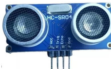
Imagen 19 - Sensor ultrasónico HC-SR04.
