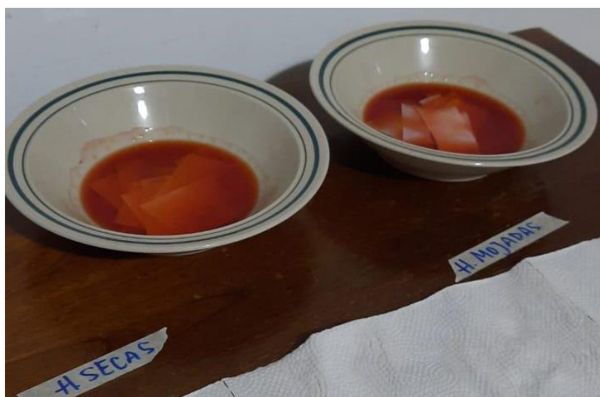
Figura 5: Mitades de huellas naturales estampadas en soportes porosos, en proceso de revelado con reactivo ORO. (1era etapa)
