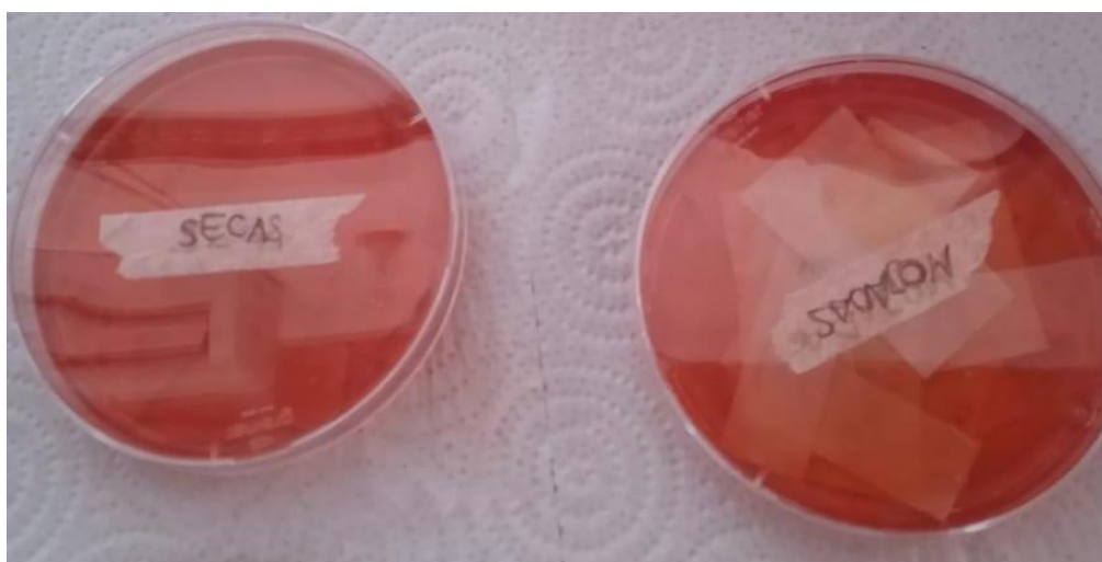
Figura 8: Mitades de huellas contaminadas estampadas en soportes porosos, en proceso de revelado con reactivo ORO. (2da etapa)
