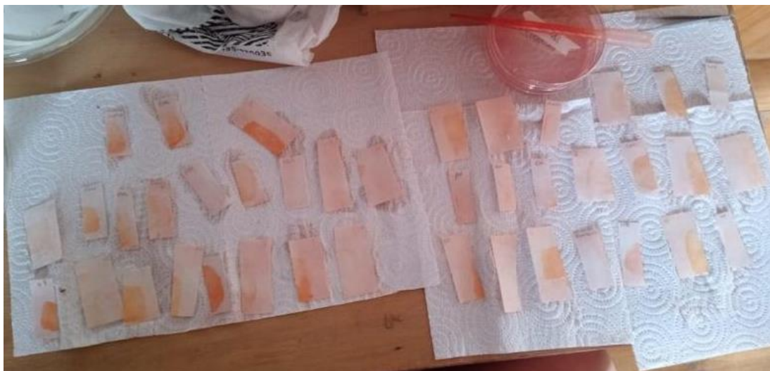
Figura 9: Soportes porosos recién retirados del reactivo donde se dejaron secar sobre papel servilleta, observándose algunas huellas.
