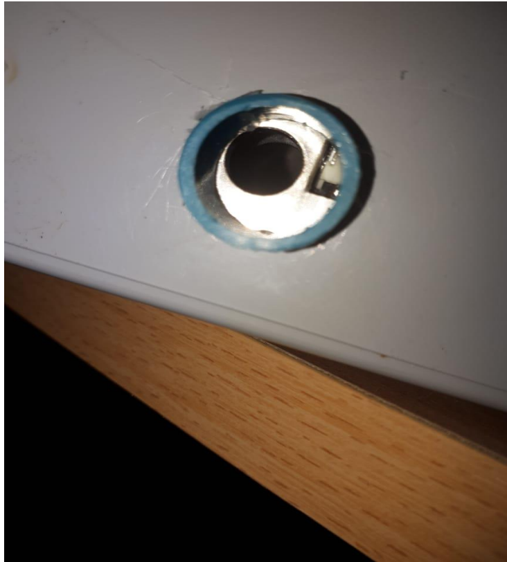
Fig.7.5: Entrada de Aire y Frente del sensor
