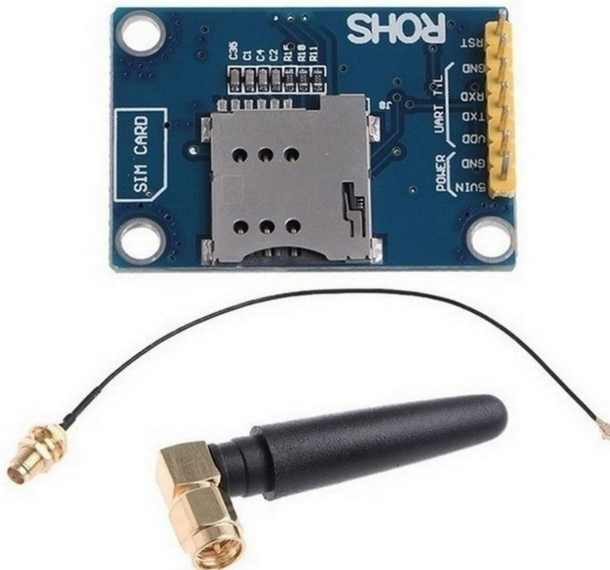
Fig.9.1: SIM 800l v2 EVB + Antena
