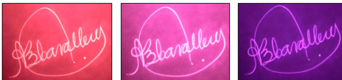
Figura 6: Fotografías con los tres filtros utilizados: 720, 760 y 850 nm
