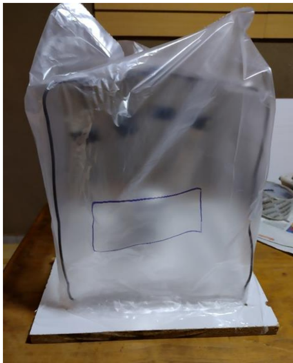
Figura A- 13:Cámara de Vapores de Cianocrilato sellada
